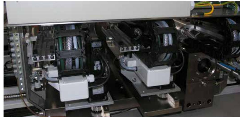
e-kette® und chainflex® Leitungen im Sondermaschinenbau für den Tiefdruck
