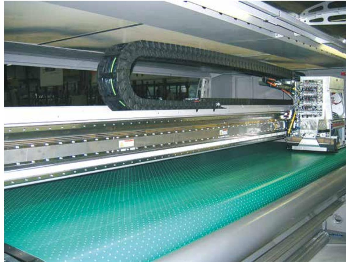
**System E6: Höchste Laufruhe, reinraumtauglich und ideal für ruckartige, schnelle Bewegungen und Richtungswechsel. Hier in einem Großformatdrucker/-plotter**
