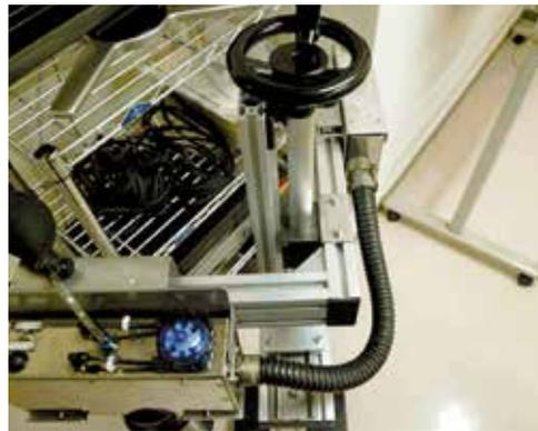
Tintenstrahlprinter mit drylin® Linearführung
