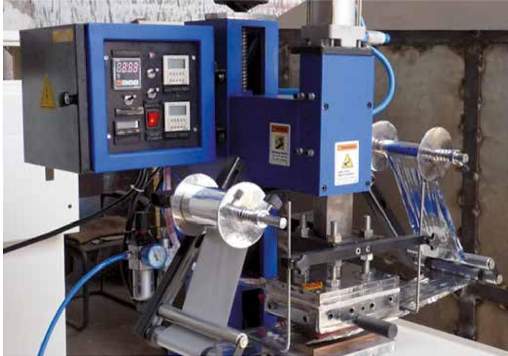
Heißfolienprägemaschine mit drylin® Antriebstechnik
