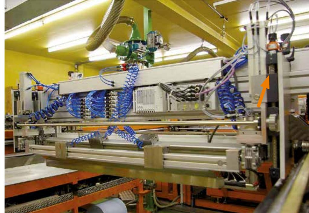
igus® drylin® Antriebstechnik und e-ketten® in Siebdruckanlage
