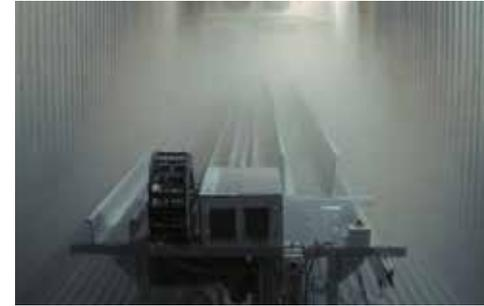
Kältestest bei -40°C von chainflex®-Leitungen und e-ketten®.
